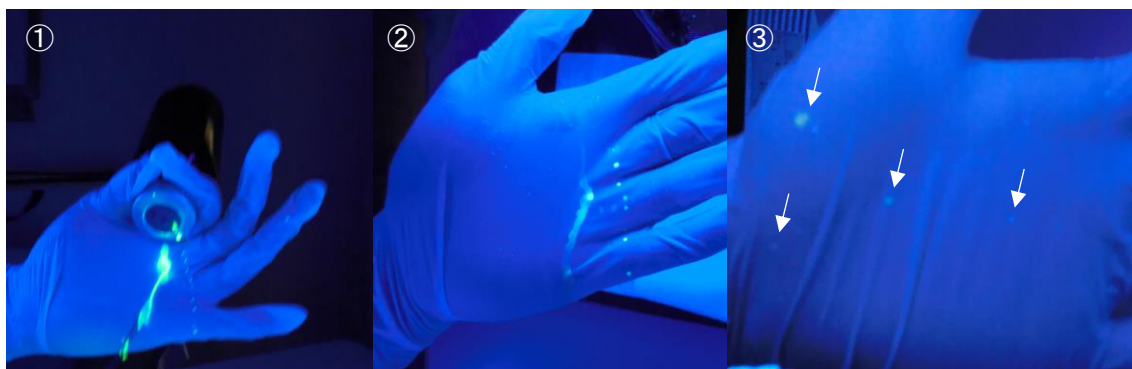
Fig. 3 バイアル内が陽圧時の内容物のスプラッシュの可視化
